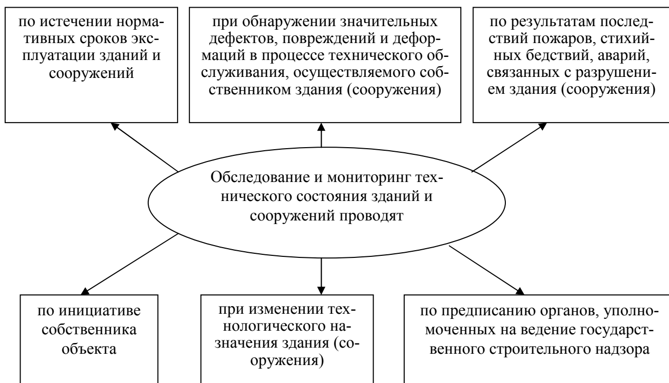
Рис. 3.1. Причины проведения обследования и мониторинга
